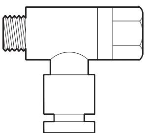
Microregolatore di flusso per cilindri
